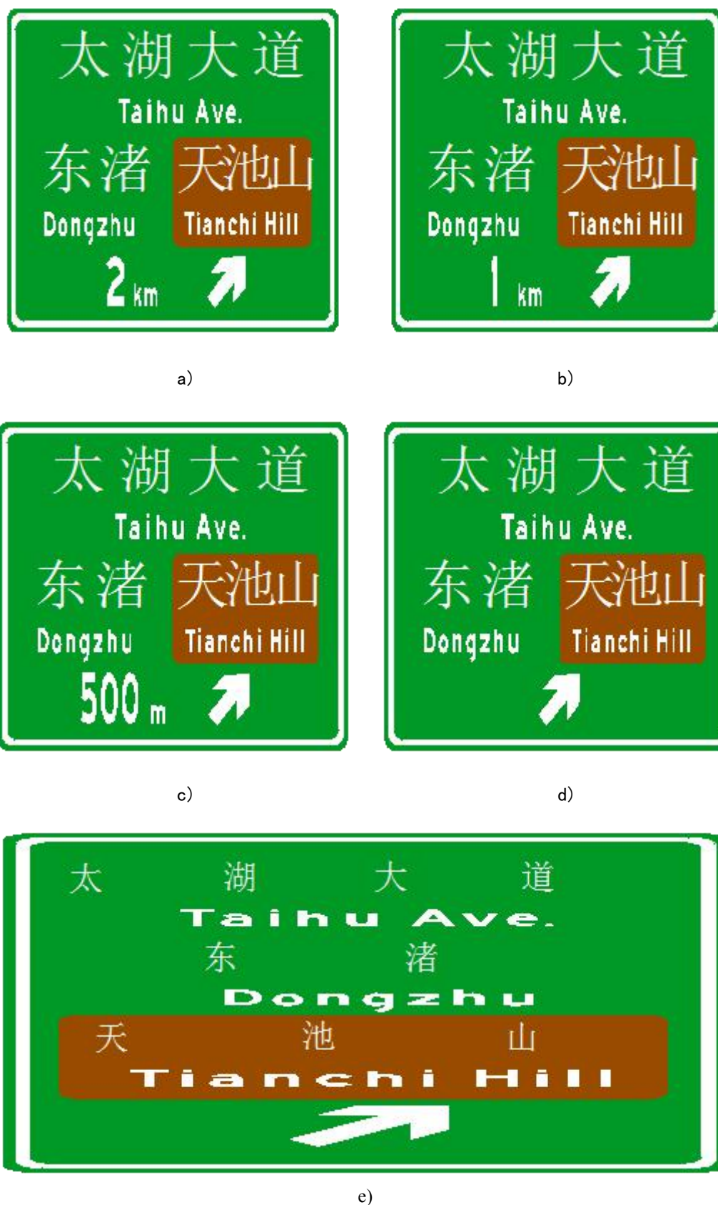
图3 作为目的地名称在高速公路主线指路标志上使用的版面示例
